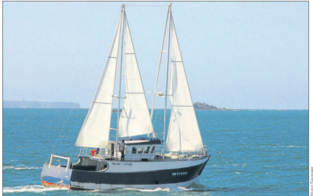
Le bureau d'études Avel Vor a développé un gréement automatisé sur un chalutier en bois de 30 ans.
